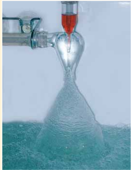
Abb. 2: Öldispersionsbäder nach Junge (nur stationär)
